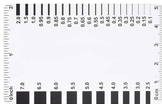
شکل (۲-۴): خط‌کش مدرج شفاف برای تعیین عرض ترک
